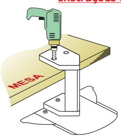
Para fixação da base do dispositivo à mesa com parafusos, pode-se usar a própria furação do dispositivo, como guia para furação.
